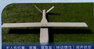
无人机机翼、尾翼、螺旋桨（转动惯性）展开状态
